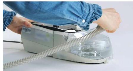
Brancher le circuit de ventilation au niveau du coude situé sur l'humidificateur.
