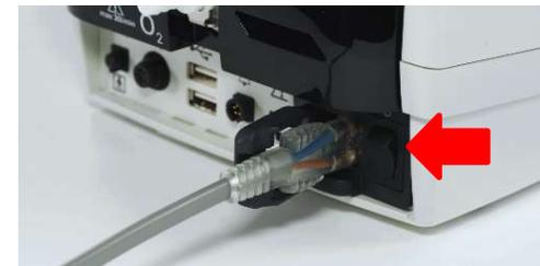
Pour allumer l'appareil, **appuyez une seule fois** sur le bouton noir (avant/arrière) situé sur le côté gauche au dos de l'appareil, puis relâchez le bouton.
