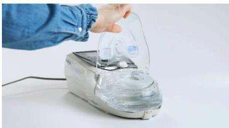
Disposez le réservoir sur la plaque chauffante de l'humidificateur.
